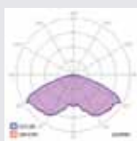
Linssi V9D - tuottaa hyvin laajan pyöreän valokeilan - soveltuu puistoihin ja puutarhoihin
