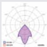
Linssi V8 - teollisuustiloihin, pysäköintihalleihin ja alikäytäviin - valokeila 90°
