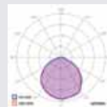
Linssi V9 - yleisvalaistukseen - lambertiaalinen valonjako
