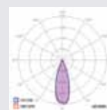
Linssi V9D - tuottaa hyvin laajan pyöreän valokeilan - soveltuu puistoihin ja puutarhoihin
