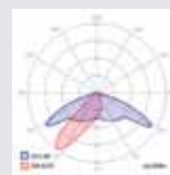
Linssi V14 - soveltuu normaaleille teille - epäsymmetrinen linssi tuottaa tasaisen valon tielle
